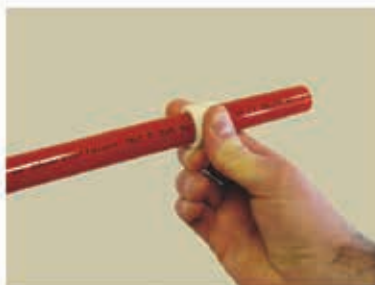
2. A szorítóhüvelyt felhelyezzük a csőre még a tágitás előtt.
